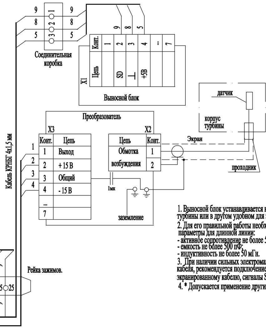
1. Выносной блок устанавливается на переднем стуле корпуса турбины или в другом удобном для эксплуатации месте.
